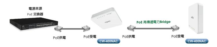
在 CW-400NAC 硬體設計使用 CERIO 獨家 PoE 再供電功能,非常適合中型以上多 PoE AP 環境架構,在建置方便性設計理念上,除了可再供電給同款 CW-400NAC 或 CERIO 旗下其他 802.3af/at標準 PoE 設計的 PoE 無線基地台使用,或只要設備符合標準的 PoE 設備產品,CW-400NAC 的 PoE Bridge 再傳遞電力功能,利用 AP 的在供電技術,輕鬆建置整體環境的 AP 部屬。
