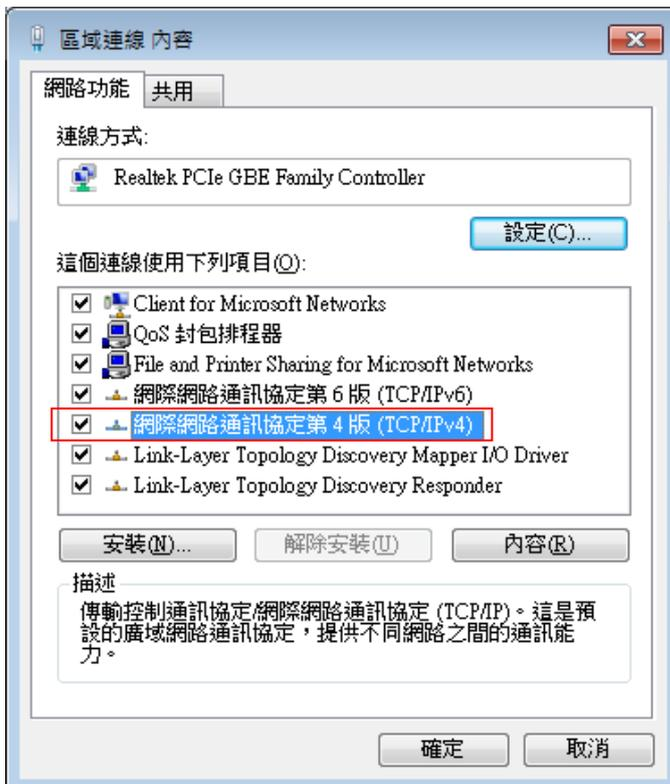
**步驟 6：** 點擊 TCP/IPv4 將進入 PC 或筆電的 IP 位址設定頁面，預設為自動取得 IP 位址，我們將它改為”使用以下的 IP 位址”，並在 IP 欄位打入與 CenOS3.0 軟體的同網段 IP 位址，例如 CenOS3.0 軟體的預設 IP 為 192.168.2.254，則 PC 或筆電的 IP 為者可以設定 192.168.2.x，x 可設定 1~至 253 之間的數值。以下圖為例，完成設定。
