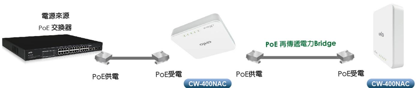
在 **CW-400NAC** 硬體設計使用 CERIO 獨家 PoE 再供電功能，非常適合中型以上多 PoE AP 環境架構，在建置方便性設計理念上，除了可再供電給同款 **CW-400NAC** 或 CERIO 旗下其他 802.3af/at 標準 PoE 設計的 PoE 無線基地台使用，或只要設備符合標準的 PoE 設備產品，**CW-400NAC** 的 PoE Bridge 再傳遞電力功能，利用 AP 的在供電技術，輕鬆建置整體環境的 AP 部屬。
